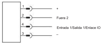
Diagrama de cableado del lado primario.
