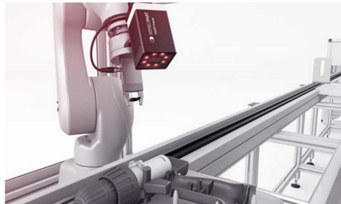
El VISOR® Robotic identifica la posición exacta del destornillador inalámbrico. Los datos de compensación se utilizan para corregir la trayectoria del robot.
