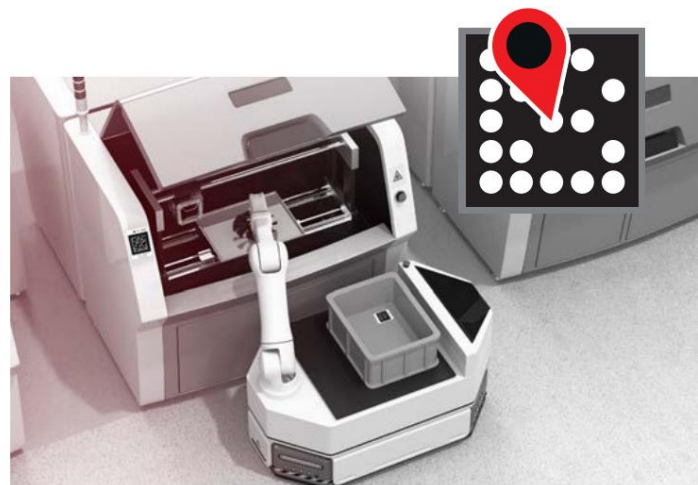
La tecnología Target Mark permite una fácil identificación y una referencia precisa de sus estaciones de trabajo móviles.
