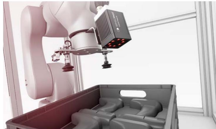
La posición de los componentes suministrados en una bandeja puede variar tanto que es necesaria la guía del robot.
