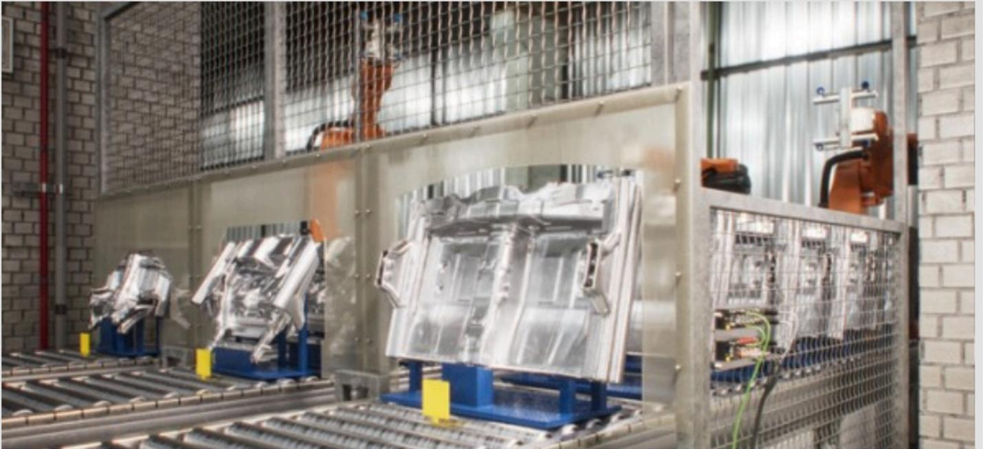
Dado que las cadenas de montaje suelen cargarse manualmente, requieren tecnología de seguridad
