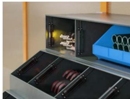
Los sensores PVS crean un campo de detección 2D que puede detectar cuando alguien mete la mano dentro de un contenedor para coger una pieza.
