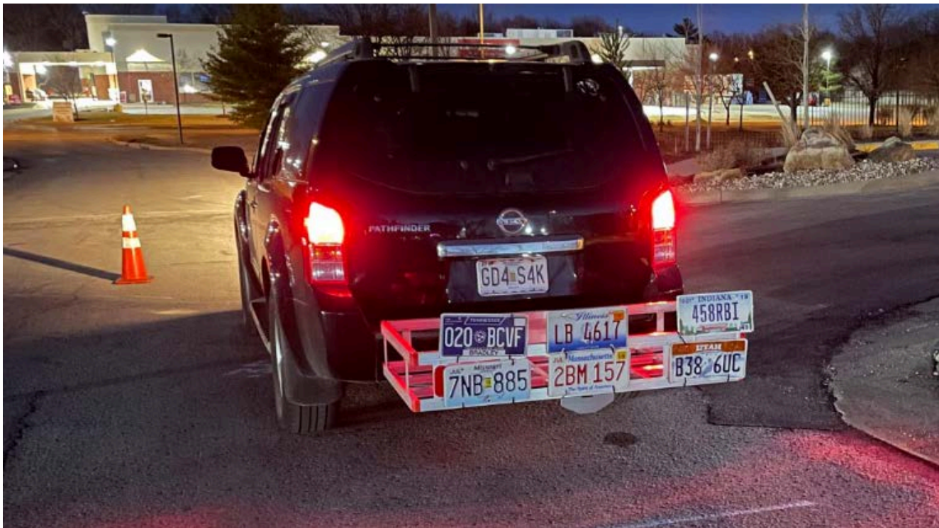
Comparación de placas retrorreflectantes y no retrorreflectantes. Tennessee e Indiana se encuentran en la parte superior izquierda y superior derecha, respectivamente.
