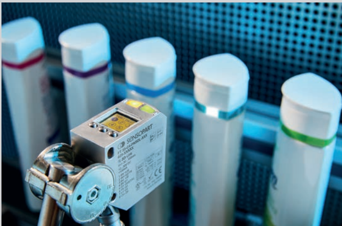
Detección de color de los elementos de embalaje
