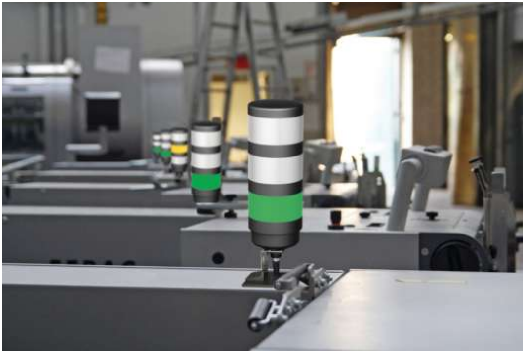
Las luces de torre inalámbricas permiten a los usuarios seguir tendencias en el tiempo de funcionamiento de la máquina y en el tiempo por ciclo.
