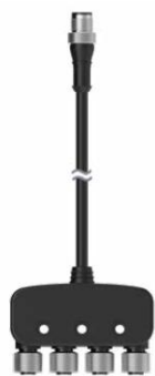
Conector A de 5 pines (Tensión: 30 V CC/CA, Corriente: 4 A, AWG: 4 x 22, Diámetro del cable: 5,6 mm)
