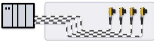
E/S cableadas directamente
