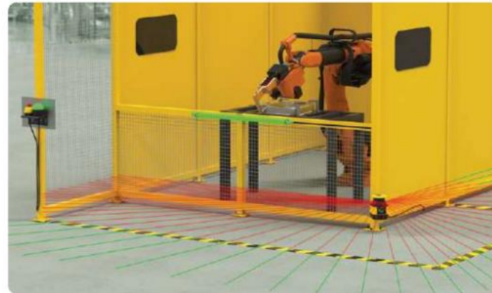
La interfaz del software facilita la creación de zonas de seguridad y advertencia personalizadas para proteger áreas grandes, complejas y de forma irregular.
