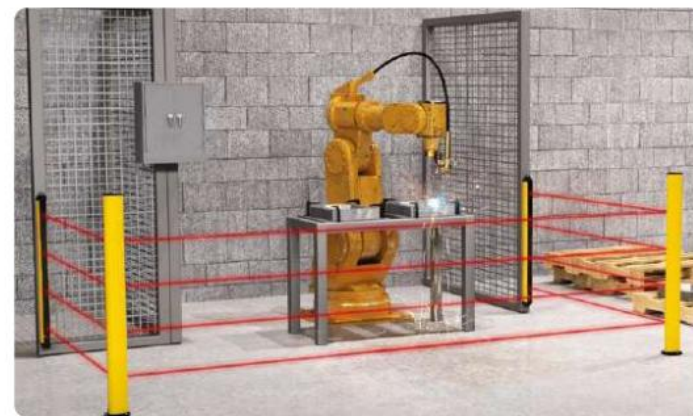
Los sistemas de rejilla de seguridad SGS están disponibles en modelos emisor/receptor capaces de proporcionar protección a distancias muy largas y en modelos activo/pasivo de fácil instalación.
