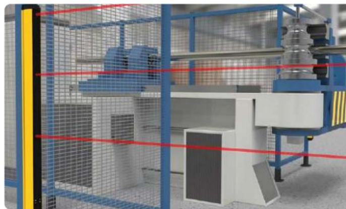
Los sistemas de rejilla de seguridad SGS, con dos, tres o cuatro haces, se utilizan para monitorizar el perímetro de la zona de trabajo.
